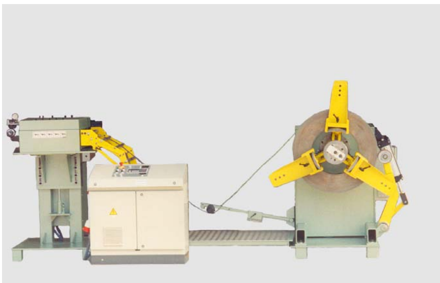
Abroll-Richt-Vorschubanlage mit motorisiertem Haspel für Breitband
