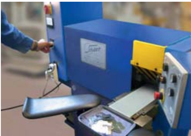
Wirkt entspannend: Feinrichtmaschine mit 6 mm Walzendurchmesser zum Richten von Kleinteilen
